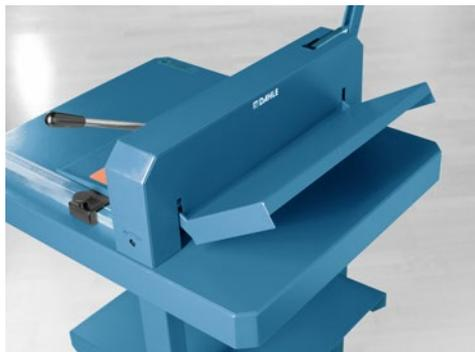
Robuste Messerschutzhauben aus Metall decken bei der Stapel-Schneidemaschine 842 den Arbeitsbereich während des Schneidens vollständig ab
